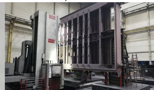
Mechanische Bearbeitung Schleusentor
